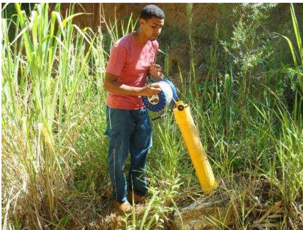
FOTOGRAFIA 18 - Piezômetro PML – 19 - Sítio Campo Alegre – Lixão de Anta – Piezômetro deslocado do eixo vertical.
