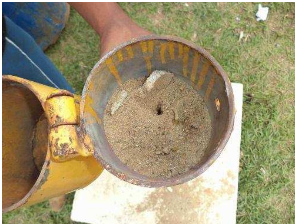
Fotografia 01 – Piezômetro PML 27 (Estação de Anta) obstruído na profundidade 1,39m. Data: 09/10/13.
