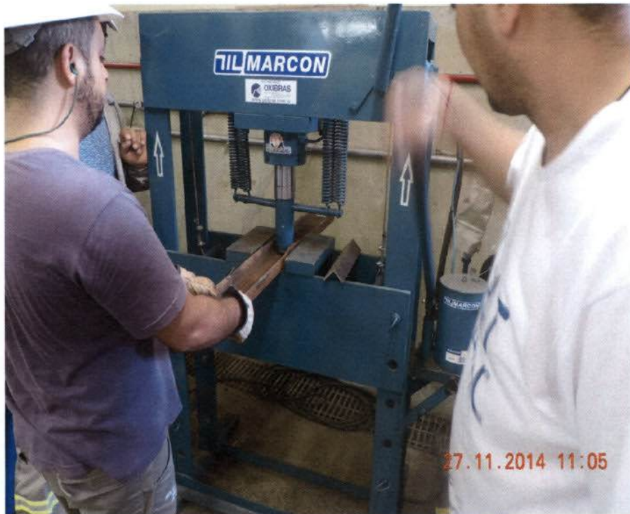
Peças do mata-burro sendo desempenada na prensa hidráulica da Oficina Eletromecânica da UHE SF.
