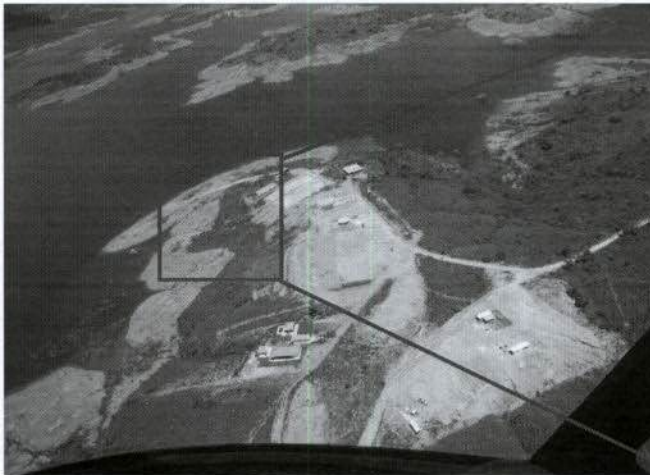
Figura 39: Loteamento próximo à ponte dos carpinas com corte e aterro irregular já mostrando sulcos erosivos.
