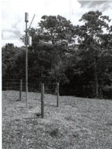
Figura 07: Seção PB – linígrafo L3 em trecho lótico do rib. Batalha, braço formador do reservatório da UHE Serra do Facão.
