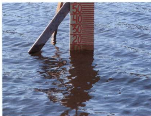
Foto 23: Régua para acompanhamento da cota do reservatório durante o enchimento. No dia 02/02/2010 as 18h 48min a cota estava em 729,04.
