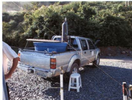
Foto 20: Caminhonete adaptada para armazenamento e transporte dos peixes capturados, de jusante para montante, dotada de cilindro para aeração da água.
