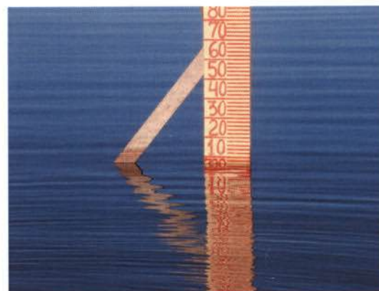
Foto 22: Régua para acompanhamento da cota do reservatório durante o enchimento. No dia 02/02/2010 as 7h 52min a cota estava em 728,96.
