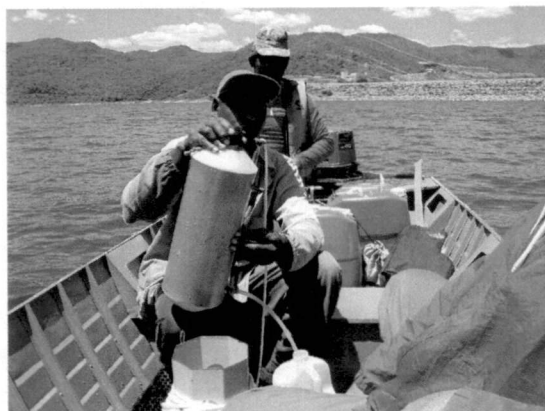
Foto 10 - Coleta de amostras de água com a garrafa de Van Dorn nas profundidades da estação MRN-50.
