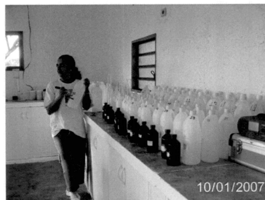
Foto 12 - Marcação dos frascos de amostras de água para determinações laboratoriais.
