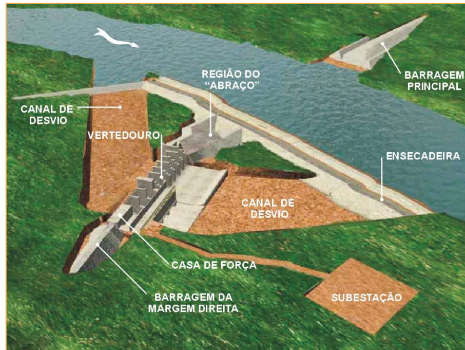
Figura 3.5. Término da escavação do canal de desvio. Continuação da concretagem das estruturas do vertedouro e da casa de força.
