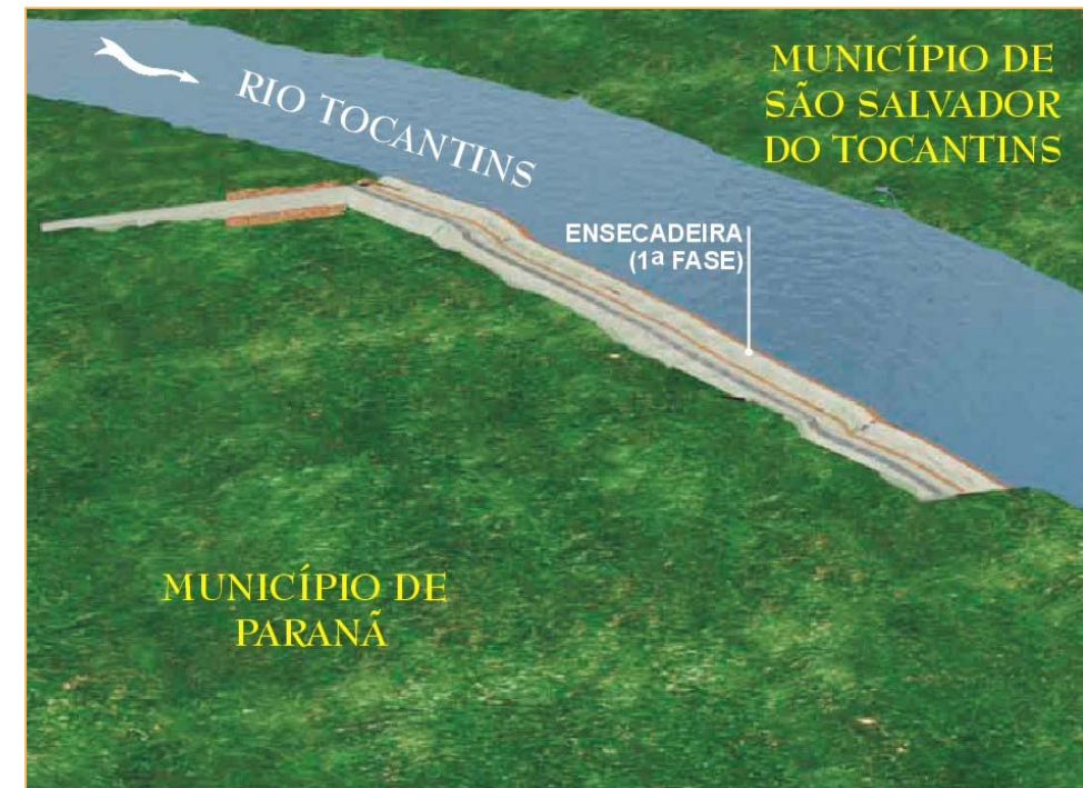
Figura 3.2. Construção da Ensecadeira de 1ª fase.
