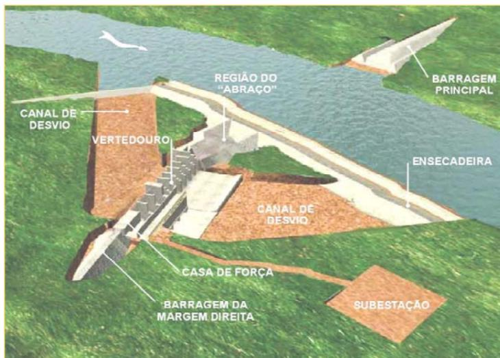
Concretagem do vertedouro, tomada d'água e casa de força. Implantação das barragens de terra nas margens direita e esquerda. Escavação e aterro da área da subestação
