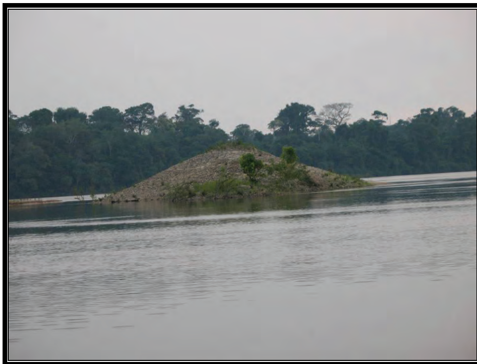
Foto 3.4.3-9 - Ilha formada pelo resto do garimpo de dragagem no trecho amostrado do rio São Benedito.
