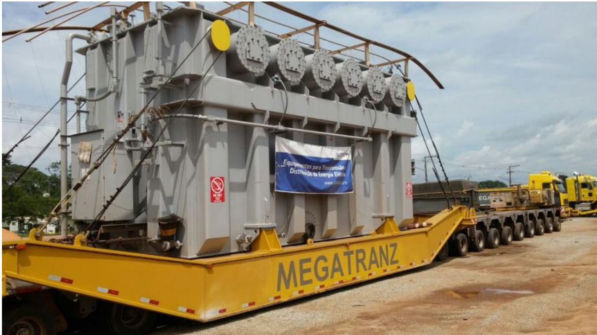
Transformador de Elevação estacionado em Alta Floresta.
