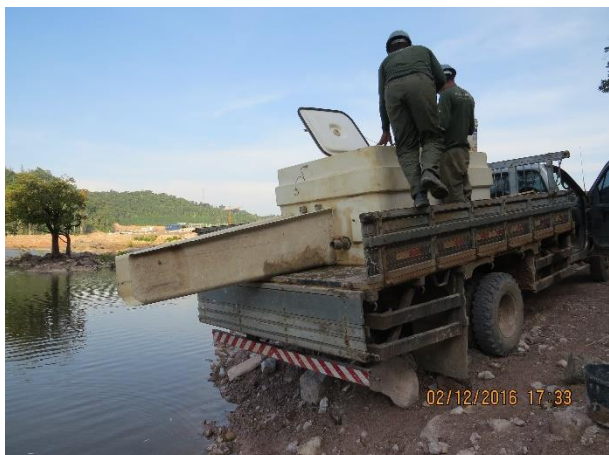
Figura 37. Rampa para soltura dos peixes.
