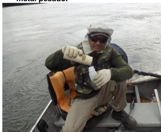
Figura 1-30: Após a coleta, o material retido na rede foi fixado em formalina a 10% tamponada, em frascos plásticos devidamente identificados.
