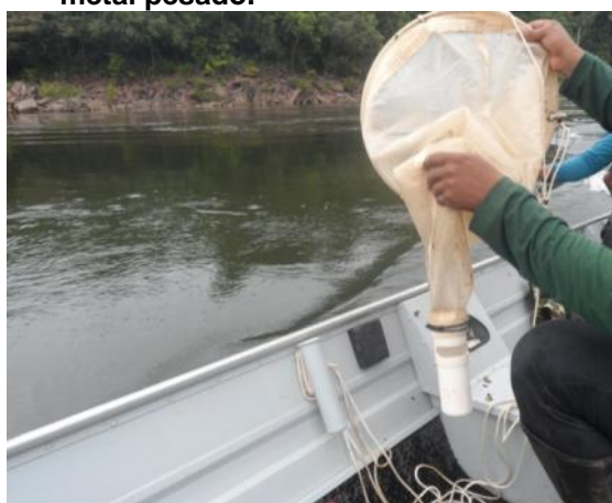
Figura 1-29: Detalhe do copo coletor instalado na extremidade posterior da rede de ictioplâncton, no qual as larvas e ovos ficam retidos.
