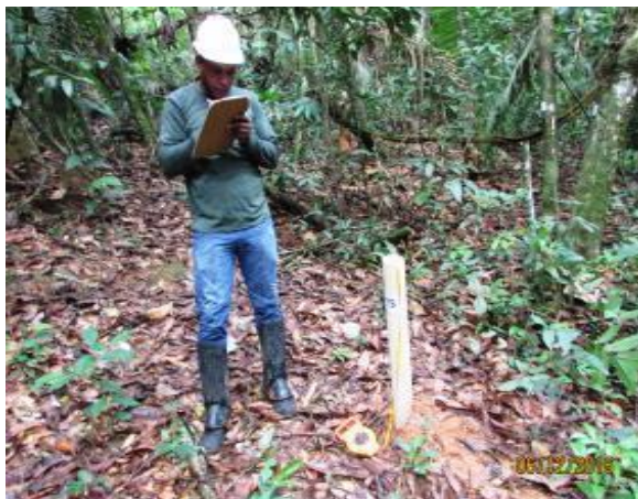
Figura 21: Piezômetro instalado em parcela do módulo amostral.
