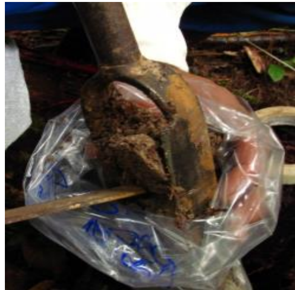
Figura 18: Procedimentos de coleta e armazenamento de solo para análise laboratorial.
