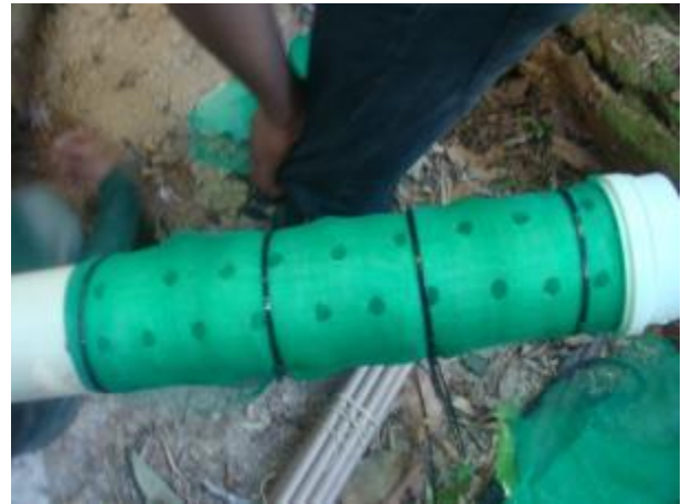
Figura 20: Detalhe do filtro confeccionado para o piezômetro.
