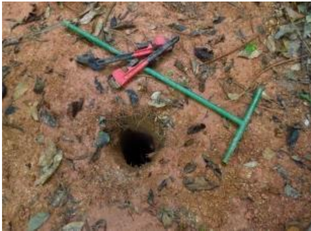
Figura 19: Material usado no procedimento de instalação do piezômetro em parcela dos módulos do monitoramento da flora.
