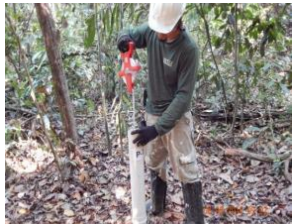
Figura 22: Leitura do piezômetro para mensuração do nível do lençol freático.
