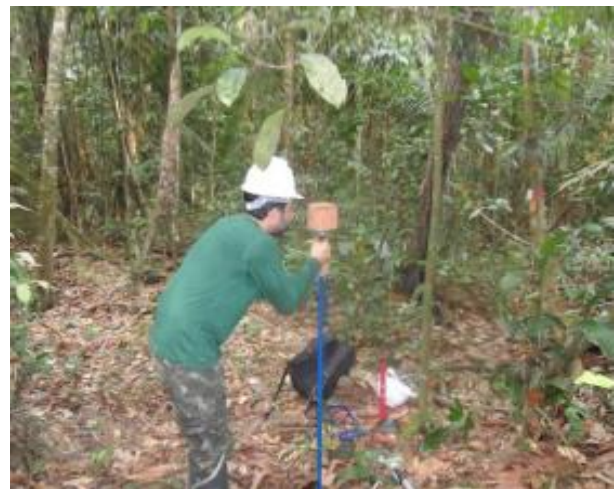
Figura 2: Alinhamento para a abertura de trilhas e determinação do polígono das parcelas amostrais.
