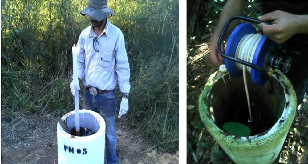
**Figura - 4: Amostragem de água com o amostrador do tipo bailer e medição do Nível d'água.**
