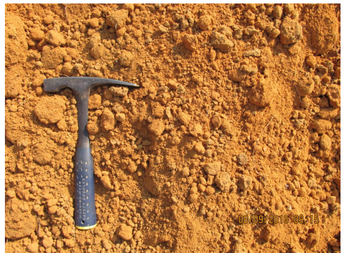
Foto IMG_02931 - Detalhe do sedimento arenoso com matriz silto/argilosa.
