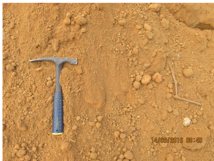
Foto IMG_02949 - Detalhe do sedimento arenoso com matriz silto/argilosa.
