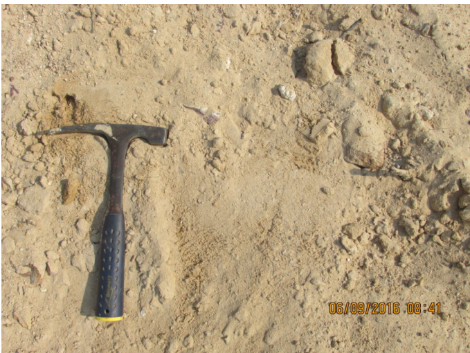
Foto IMG_02919 - Detalhe do sedimento arenoso com matriz silto/argilosa.
