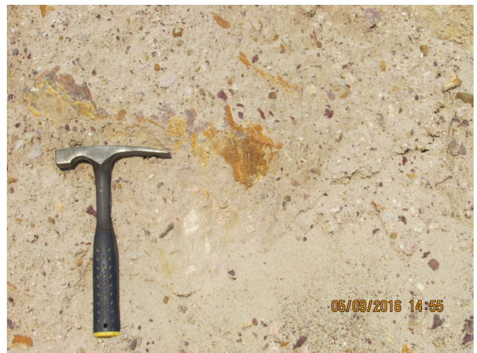
Foto IMG_02909 - Detalhe do sedimento arenoso com matriz silto/argilosa.
