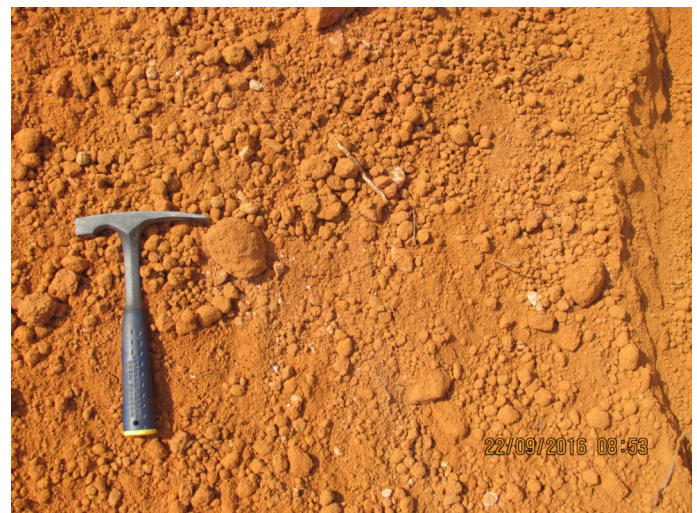
Foto IMG_03008 - Detalhe do sedimento arenoso com matriz silto/argilosa.
