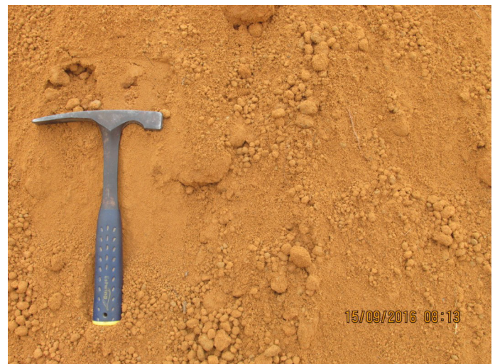
Foto IMG_02961 - Detalhe do sedimento arenoso com matriz silto/argilosa.
