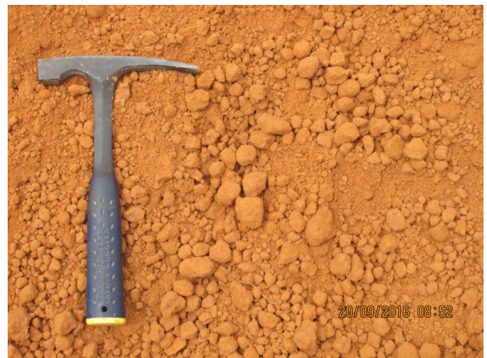
Foto IMG_02992 - Detalhe do sedimento arenoso com matriz silto/argilosa.
