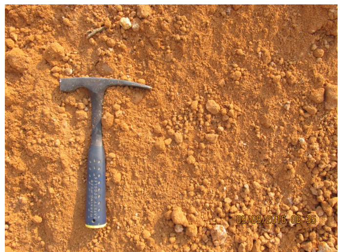
Foto IMG_02940 - Detalhe do sedimento arenoso com matriz silto/argilosa.
