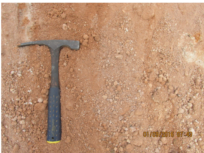
Foto IMG_02899 - Detalhe do sedimento arenoso com matriz silto/argilosa.
