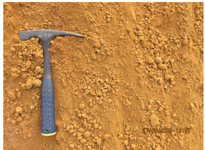
Foto IMG_02999 - Detalhe do sedimento arenoso com matriz silto/argilosa.
