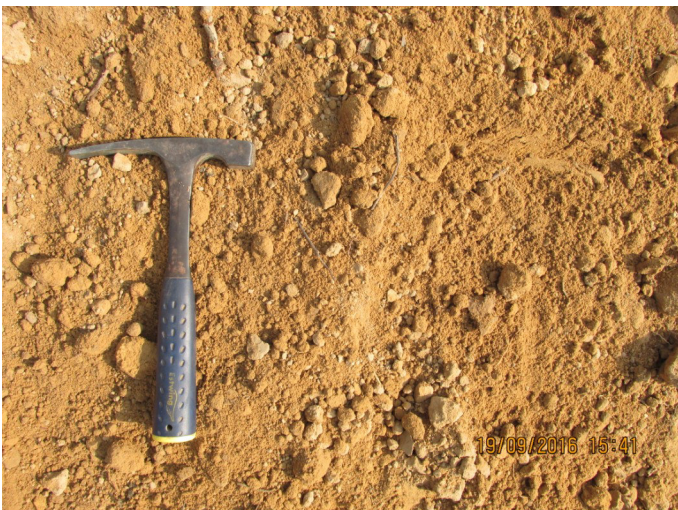
Foto IMG_02982 - Detalhe do sedimento arenoso com matriz silto/argilosa.
