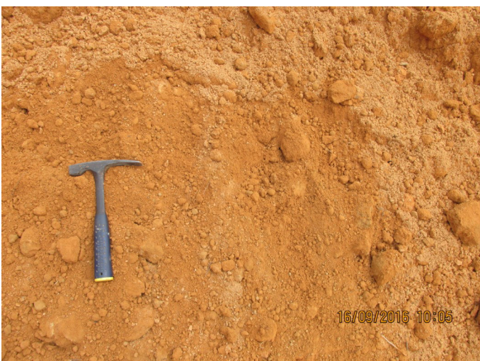
Foto IMG_02970 - Detalhe do sedimento arenoso com matriz silto/argilosa.
