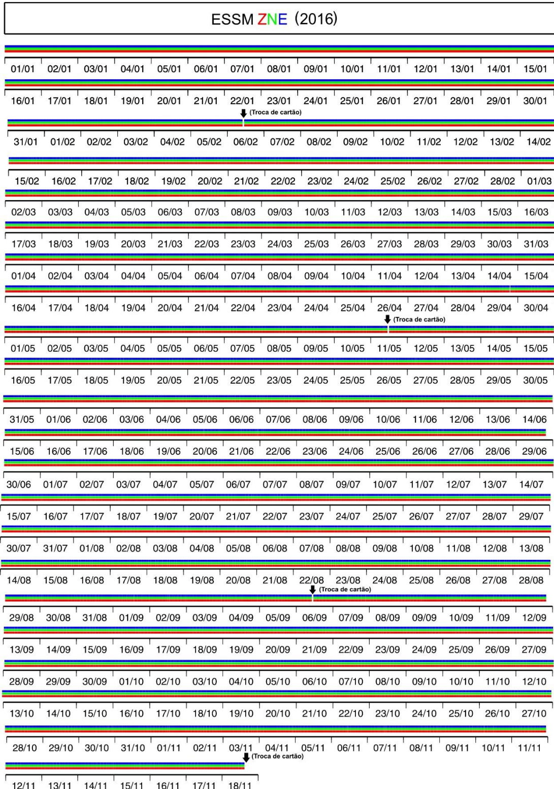
Figura 2: Gráfico de funcionamento da estação ESSM no ano de 2016, com destaque em cores para o funcionamento de cada componente da estação (Vertical em vermelho, Norte-Sul em verde, e Leste-Oeste em azul). Os números abaixo dos traços representam o dia e o mês de funcionamento, respectivamente. A estação funcionou plenamente no período avaliado.
