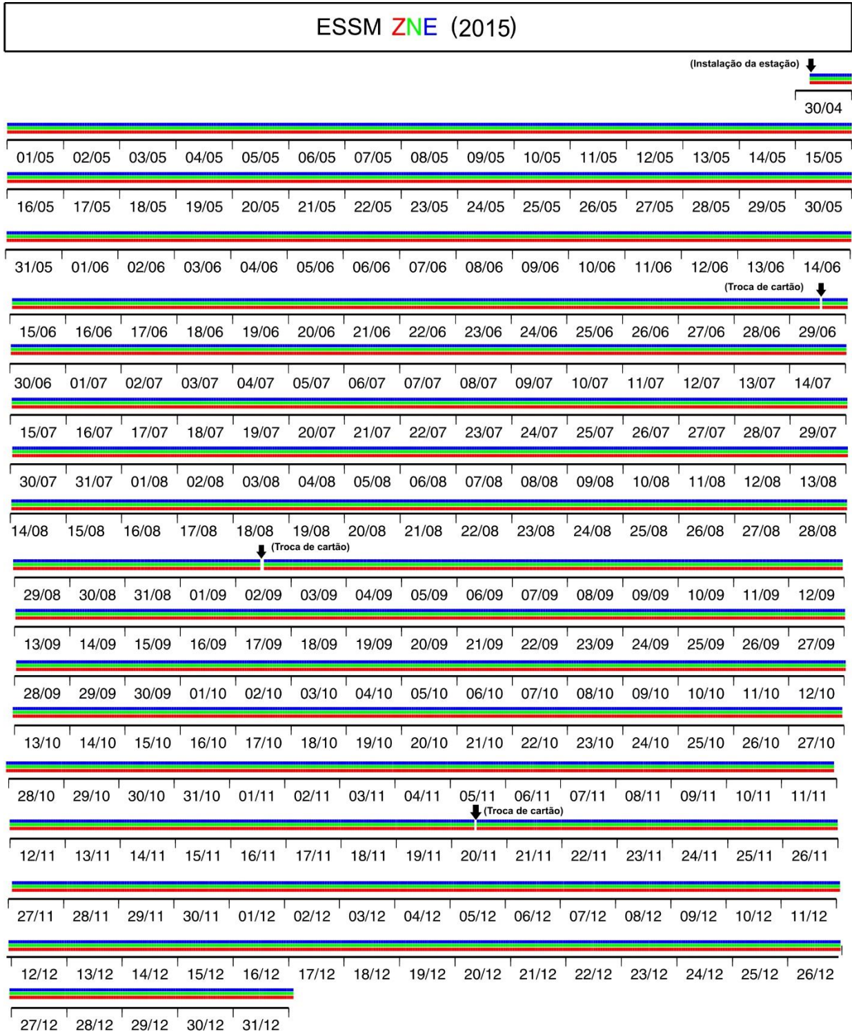
Figura 1: Gráfico de funcionamento da estação ESSM no ano de 2015, com destaque em cores para o funcionamento de cada componente da estação (Vertical em vermelho, Norte-Sul em verde, e Leste-Oeste em azul). Os números abaixo dos traços representam o dia e o mês de funcionamento, respectivamente. A estação funcionou plenamente no período avaliado.
