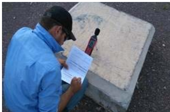
Figura - 41 Avaliação de ruído na área de alojamentos
