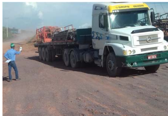
Figura - 56 - Avaliação de fuligem com Escala Ringelmann.
