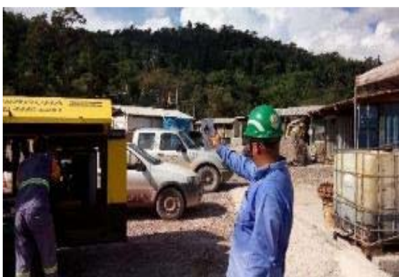
Figura - 55 - Avaliação de fuligem com Escala Ringelmann.
