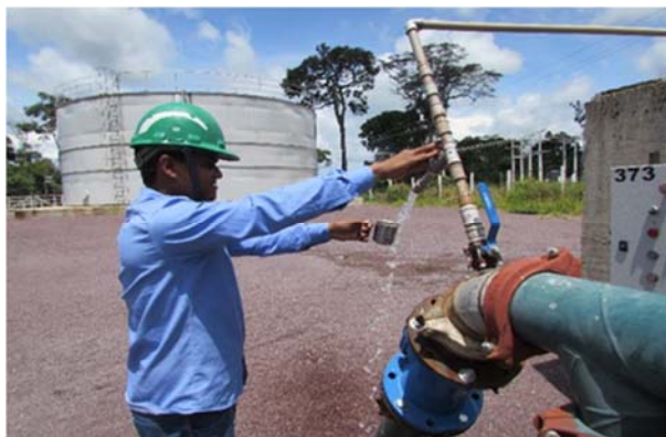
Figura - 29 -Análise de água. Operador da ETA realizando coleta (à esquerda); bancada do laboratório interno da ETA (à direita).
