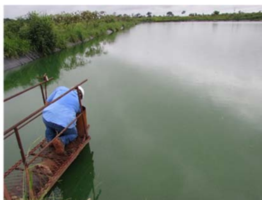
Figura - 34 - Coleta do efluente sanitário. À esquerda: medidor de entrada de vazão, calha Parshall. À direita: saída do sistema de lagoas.
