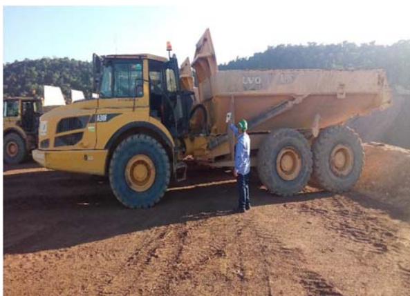
Figura - 53 - Avaliação de fuligem com Escala Ringelmann em equipamento pesado.
