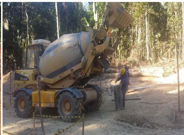
**Figura - 11: Detalhe do equipamento de autobetoneira compacta.**
