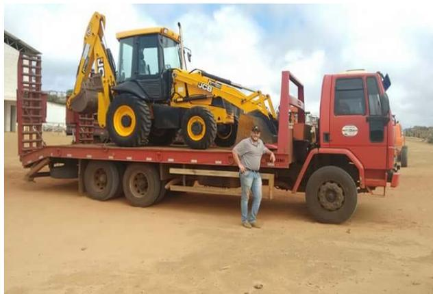
**Figura - 48: Transporte de máquinas em caminhão prancha**
