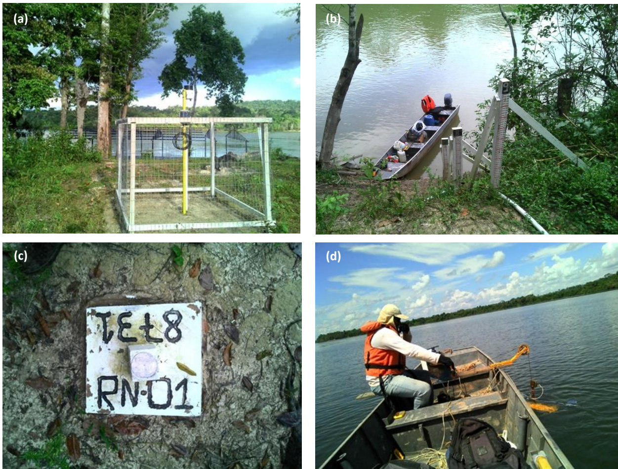
Figura 4.2: Campanhas de campo realizadas nas estações hidrométricas da UHE São Manoel. (a) Estação telemétrica; (b) Seção de réguas; (c) RN (Referência de Nível); e (d) Medição de vazão com o molinete hidrométrico.
