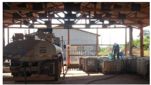
Figura 111: Retirada de resíduos líquidos perigosos
