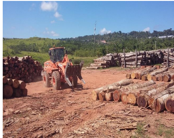
Figura 13-16 - Organização das toras nos pátios finais com o uso de pá carregadeira adaptada com garfo florestal.
