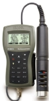
Figura 11: Sonda multiparamétrica modelo HANNA HI-9829 utilizada no monitoramento limnológico durante o lançamento das ensecadeiras na UHE São Manoel.
