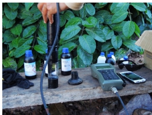
Figura 14: Procedimento de calibração dos sensores da sonda multiparamétrica modelo HANNA HI-9829 utilizada no monitoramento limnológico durante o lançamento das ensecadeiras na UHE São Manoel.
