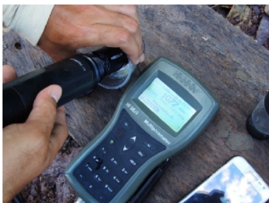
Figura 13: Procedimento de calibração dos sensores da sonda multiparamétrica modelo HANNA HI-9829 utilizada no monitoramento limnológico durante o lançamento das ensecadeiras na UHE São Manoel.
