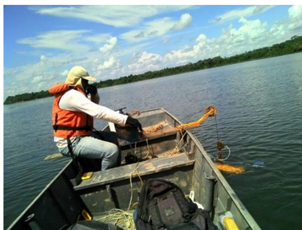
Figura 3.9.1-2 : Medição de vazão com molinete hidrométrico.
