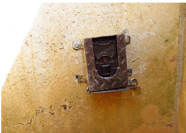
Figura 3.18-22: Armadilha fotográfica instalada com caixa de segurança na passagem fauna A.
