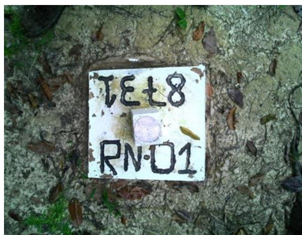
Figura 3.9.1-3: Referência de nível instalado na estação
