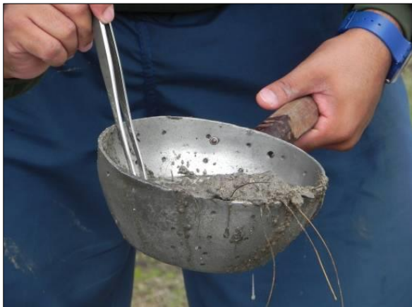
Figura 1-17: Detalhe da concha metálica de coleta e pinça.
