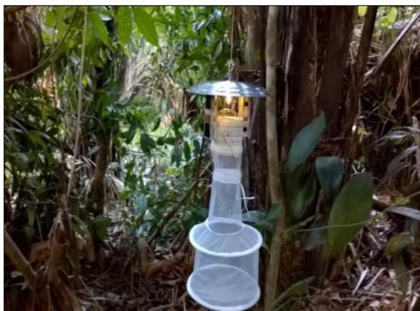
**Figura 1-3: Armadilha HP instalada em mata.**
