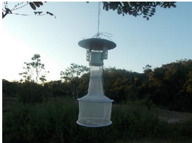
Foto 3.1.2: Armadilha do tipo CDC para captura de dípteros vetores de doenças.
