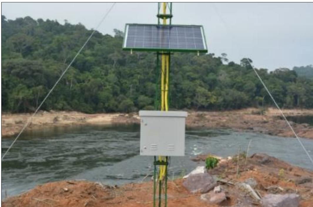
**Figura 1-11: Detalhe da caixa de montagem e painel solar da estação 02.**
