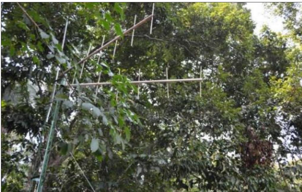
**Figura 1-14:** Detalhe do ângulo final entre as antenas, que permite que a direção do movimento do peixe seja identificada.
