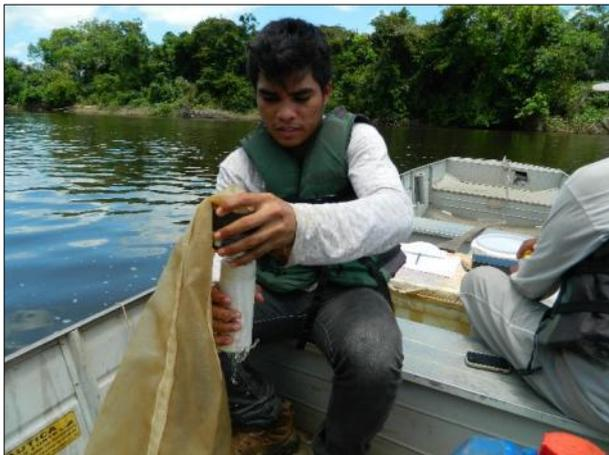
**Figura 4-12: Detalhe do copo coletor instalado na extremidade posterior da rede de ictioplâncton, no qual as larvas e ovos ficam retidos.**
