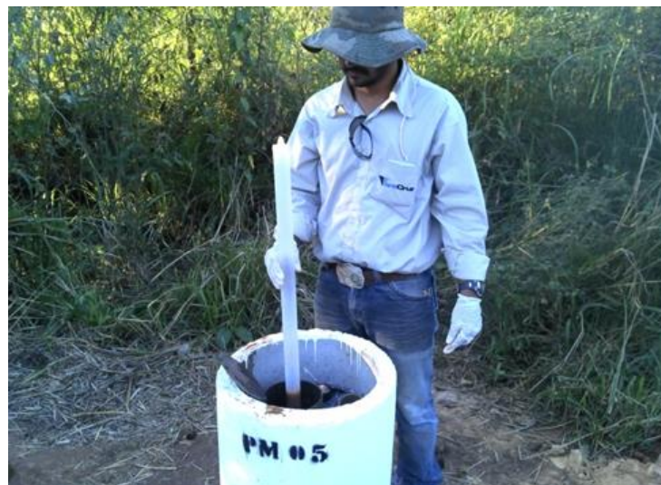
Figura 4.2. Amostragem de água com o amostrador do tipo bailer.
