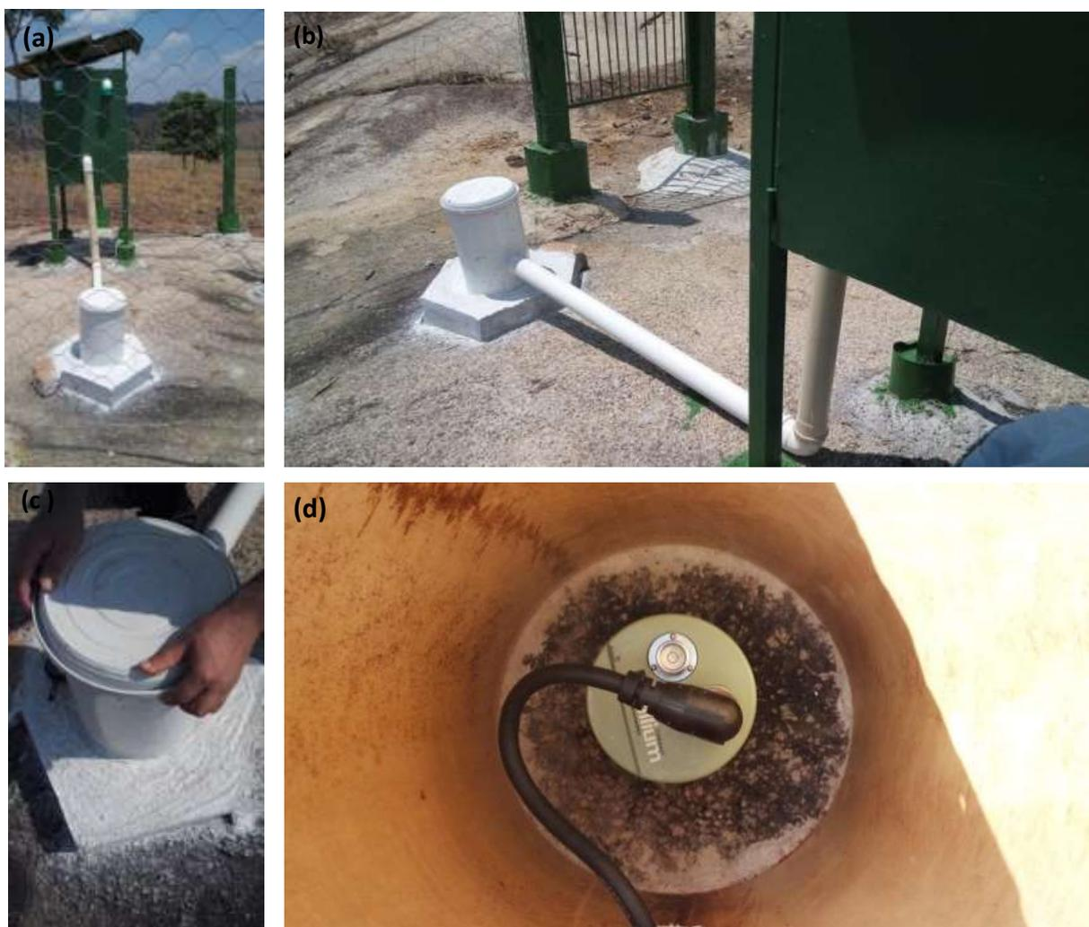
**Figura 2.1:** Manutenção da estação sismográfica UHE São Manoel; (a) Visão geral da estação; (b) Visão externa do abrigo do sensor (sismógrafo) da estação; (c) Abrigo do sensor durante a manutenção; (d) Visão do sensor da estação (sismógrafo) durante a manutenção.
