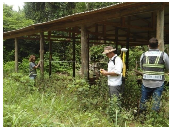
Figura 3.28-2 – Realização de levantamento topográfico das benfeitorias
