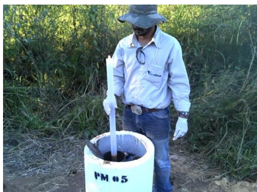
Figura 3.10-1: Amostragem de água com o amostrador do tipo bailer.
