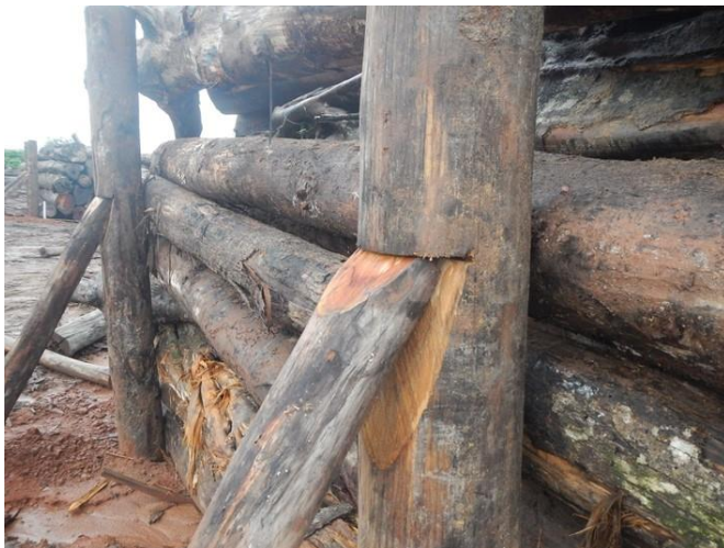
Figura 9: Detalhe de travamento de pilhas.
