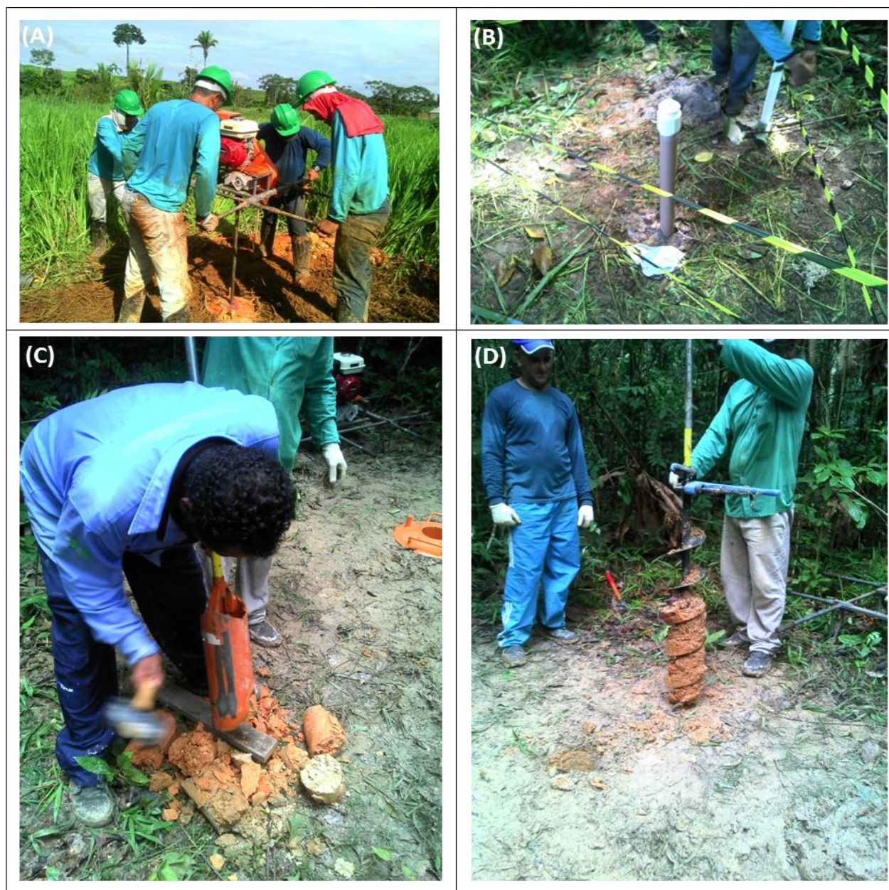
Figura 4 – Demonstração de algumas etapas para perfuração e instalação dos piezômetros. (A) perfuração do solo; (B) piezômetro instalado; (C) separação das amostras de solo; (D) trado com amostra de solo retirada da sondagem.
