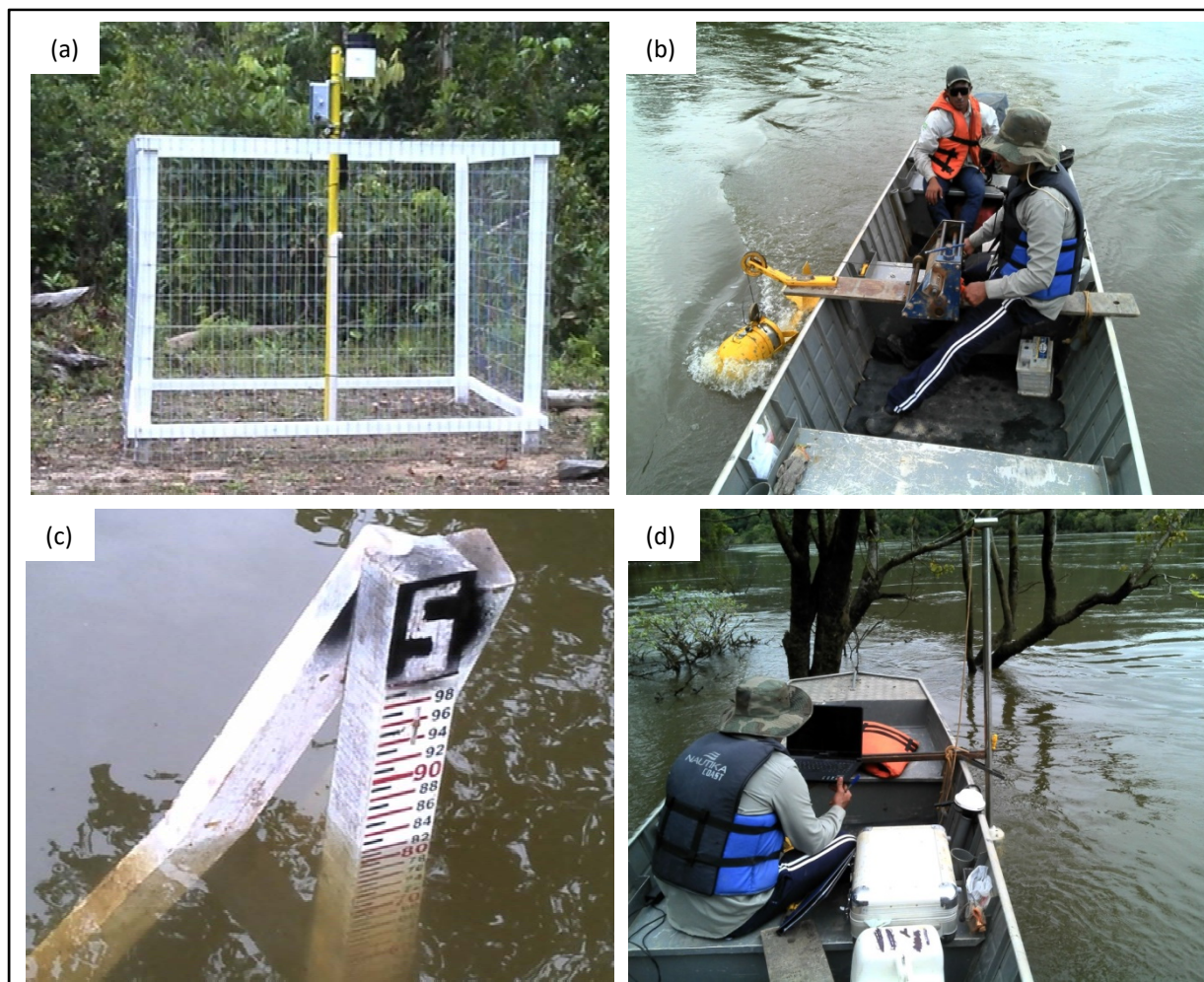
Figura 13. Campanhas de campo realizadas nas estações hidrométricas da UHE São Manoel. (a) estação telemétrica; (b) coleta de sedimento de suspensão com o amostrador de saca; (c) réguas e (d) medição de vazão com o ADCP.
