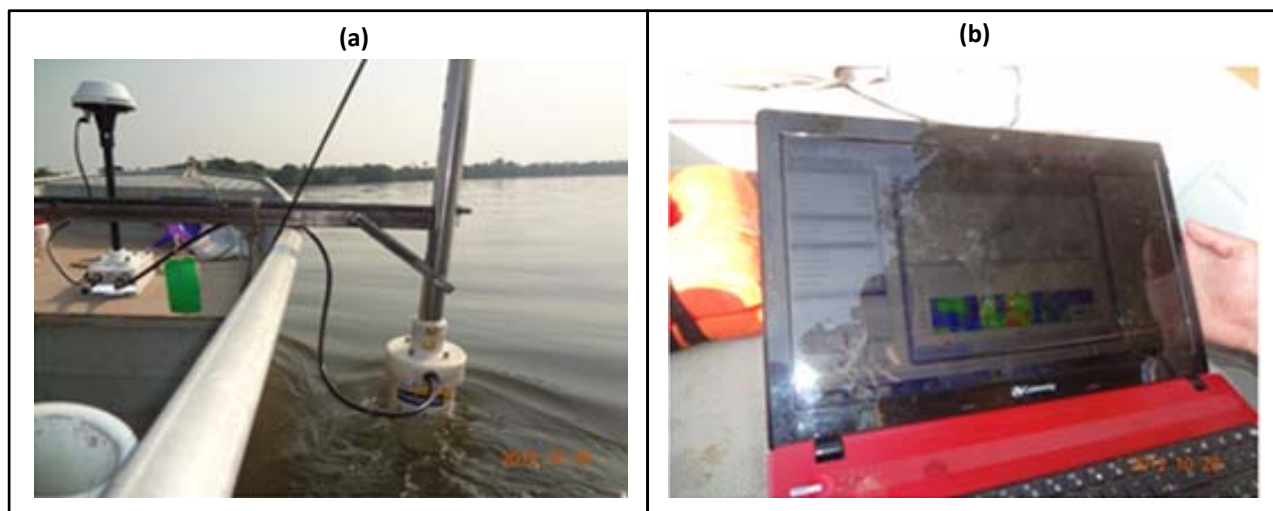
Figura 6. Medição de vazão com utilização do ADCP. (a) ADCP parcialmente submerso coletando dados; (b) notebook usado na visualização dos dados gerados e na orientação da velocidade de trânsito do barco durante a medição.
