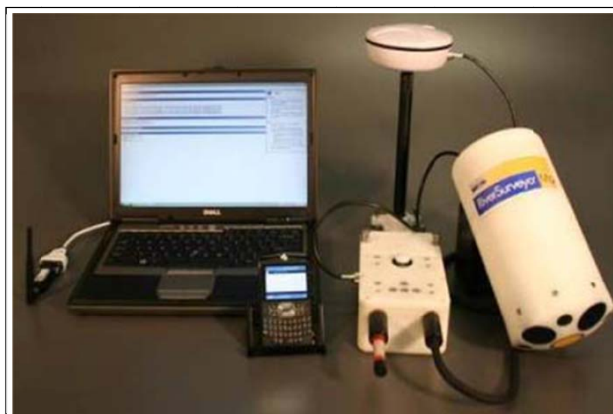
Figura 5. Hardware montado para a opção D-GPS com comunicações Bluetooth.
