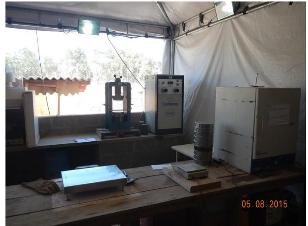
Figura 68: Vista dos equipamentos de medição da resistência do concreto.
