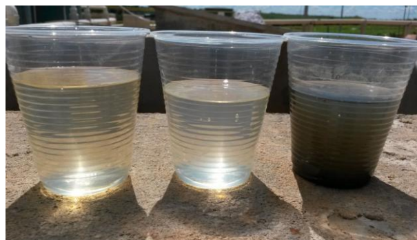
Figura 128: aspectos dos efluentes bruto (dir.), durante o processo (esq.) e tratado (centro).
