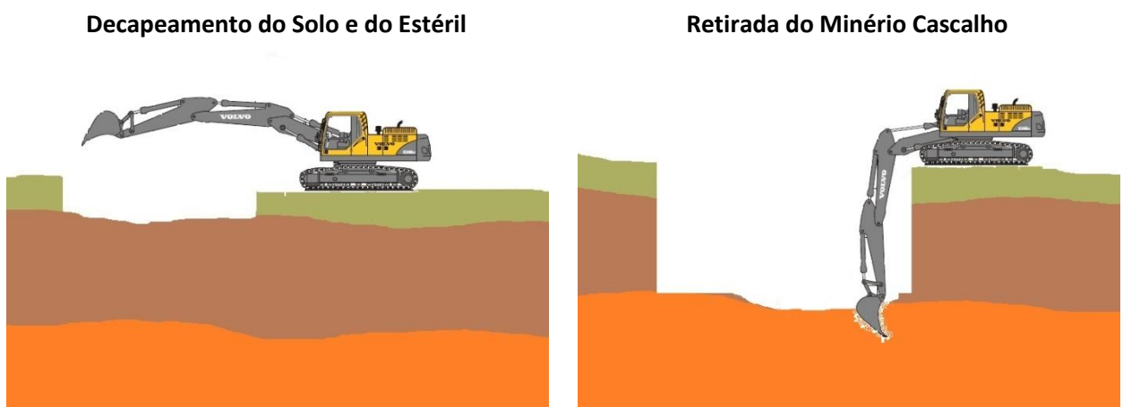
Figura 2. Desenho esquemático das atividades de lavra.
