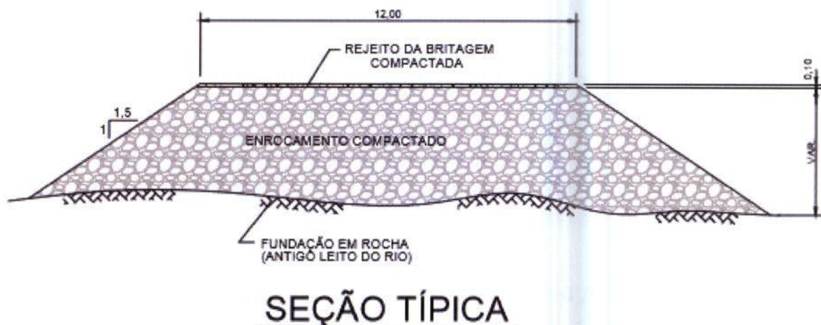
Figura 2 – Seção Típica do aterro do acesso
