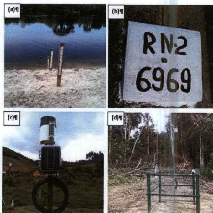
Figura 1. Exemplo de uma estação hidrométrica, incluindo: (a) lances de réguas; (b) referência de nível; (c) datalogger, pluviômetro e cabo do sensor de nível; e (d) vista geral de uma estação com o cercado.
