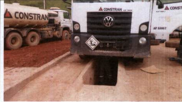
Fig. 25 – Área de troca de fluidos oleosos na oficina provisória com piso impermeável.
