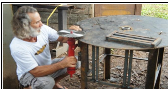
Foto17: Demonstração da máquina de corte vertical de coco de babaçu 1
