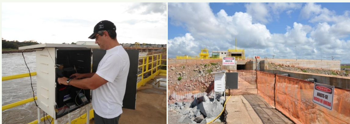
Figura 3. Base fixa e instalação de antena de radiotelemetria no STP da Ilha do Presídio.
