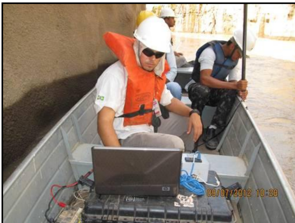
Figura 5. Detalhes da utilização de sonar (DIDISON 300m): na parte inferior do STP ilha do Presídio, UHE Santo Antônio, rio Madeira – Porto Velho - Rondônia (julho, 2012).
