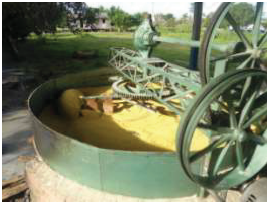
Foto 05: Forno de torrefação com movimento mecânico da farinha.
