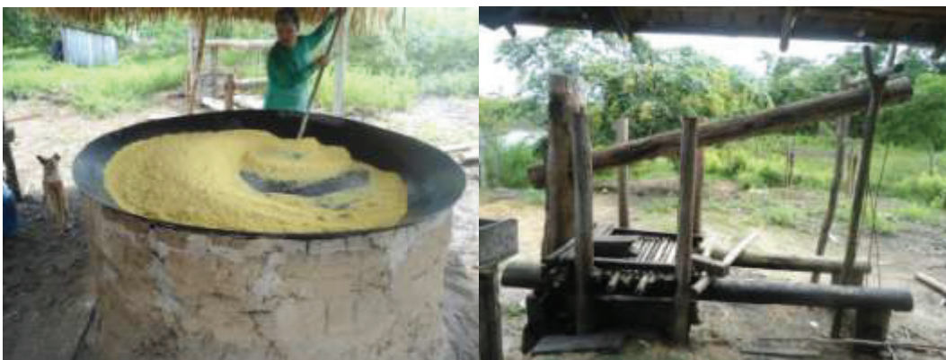
Foto 03: Torrefação da farinha em fornos circularesFoto 04: Prensa rústica com sistema de amarração.
