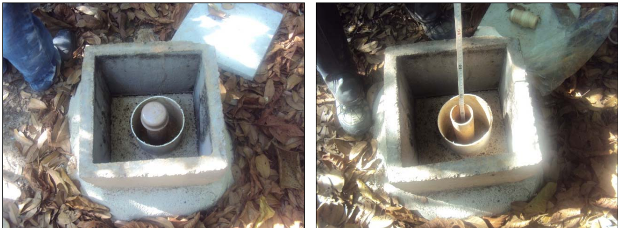
Figura 3.6-2. Medição do nível do lençol freático.
