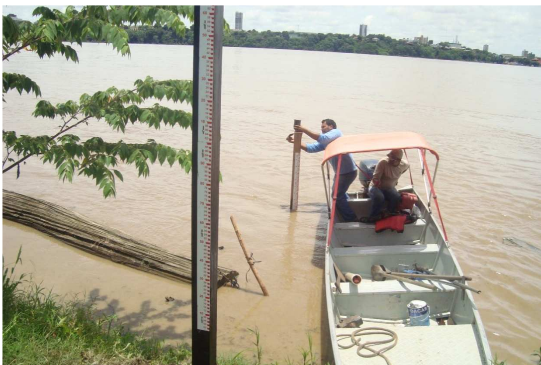
Figura 3.1. Régua Fluviométrica Instalada na Comunidade São Sebastião na Margem Esquerda do Rio Madeira a Jusante da UHE Santo Antônio
