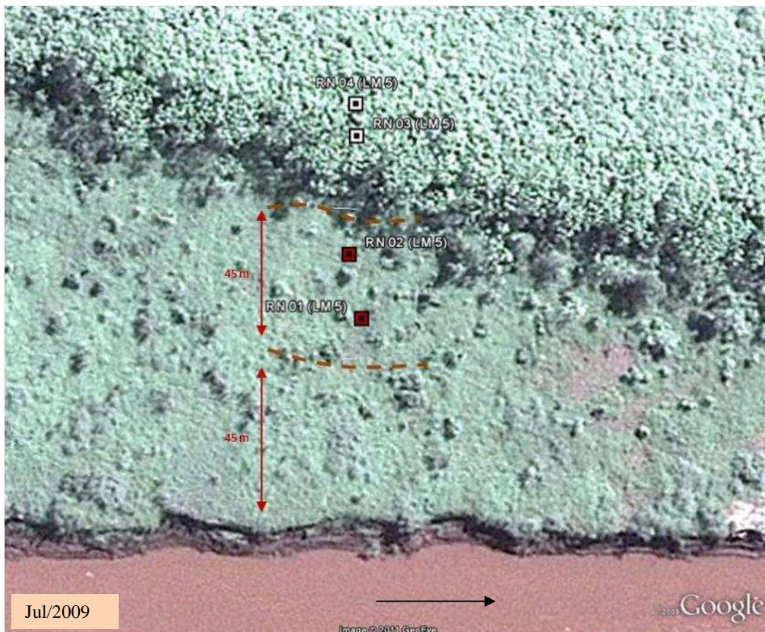
Figura 3.17. Situação da Linha de Margem do Rio Madeira e dos Marcos de Referência no Local de Monitoramento 5 para Diferentes Datas
