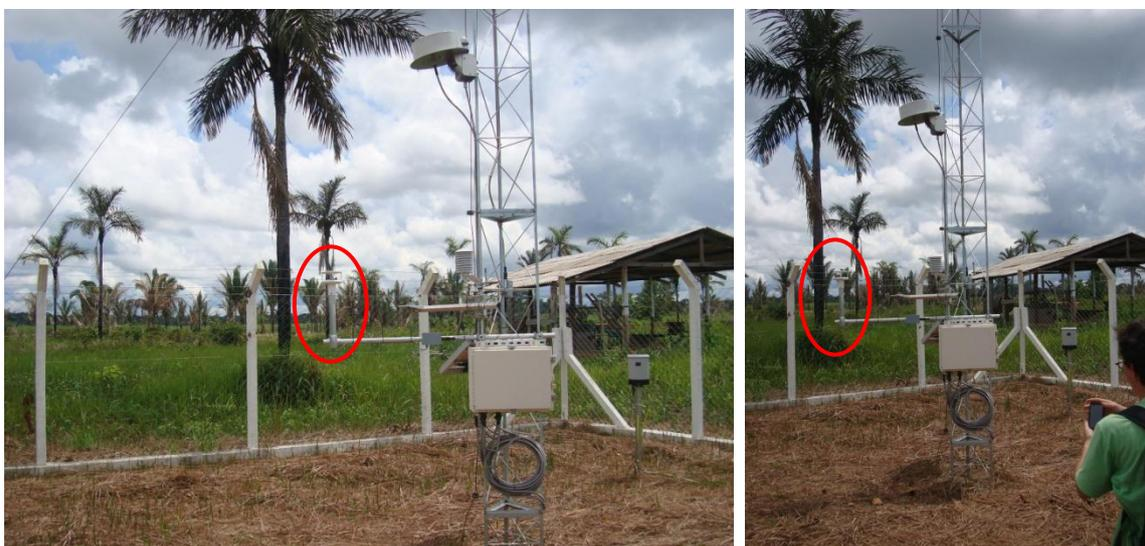
Instalação do sensor de vento a 02 (dois) metros de altura na PCD Calama.
