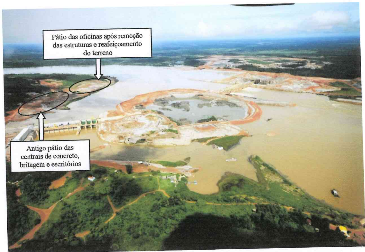
Aspecto final das áreas desmobilizadas do canteiro MD, localizadas na cota de alagamento do reservatório, depois de removidas estruturas e realizado o reafeiçoamento do terreno
