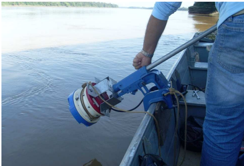
Figura 4.2. Instalação do ADCP na Borda Lateral da Embarcação
