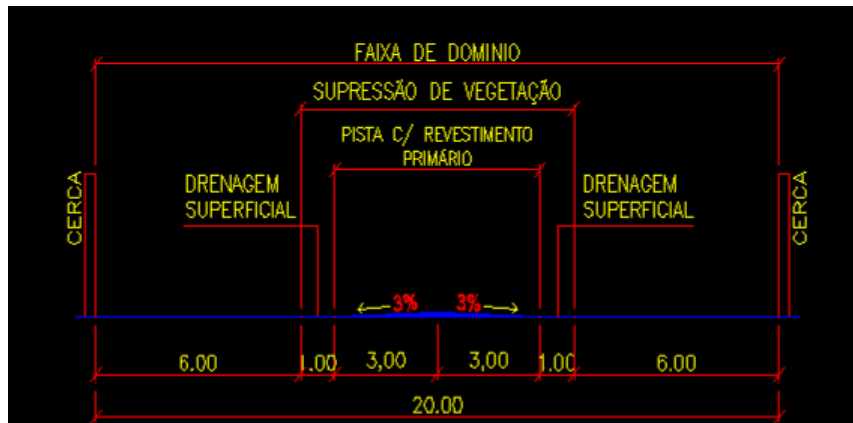
Figura 1. Seção típica da implementação das estradas vicinais.
