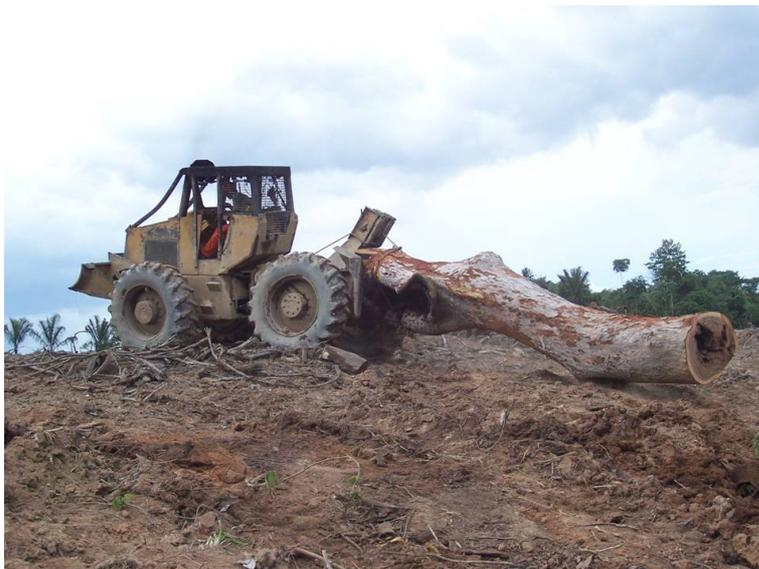
Foto 3 – arraste de tora com utilização de Skidder
