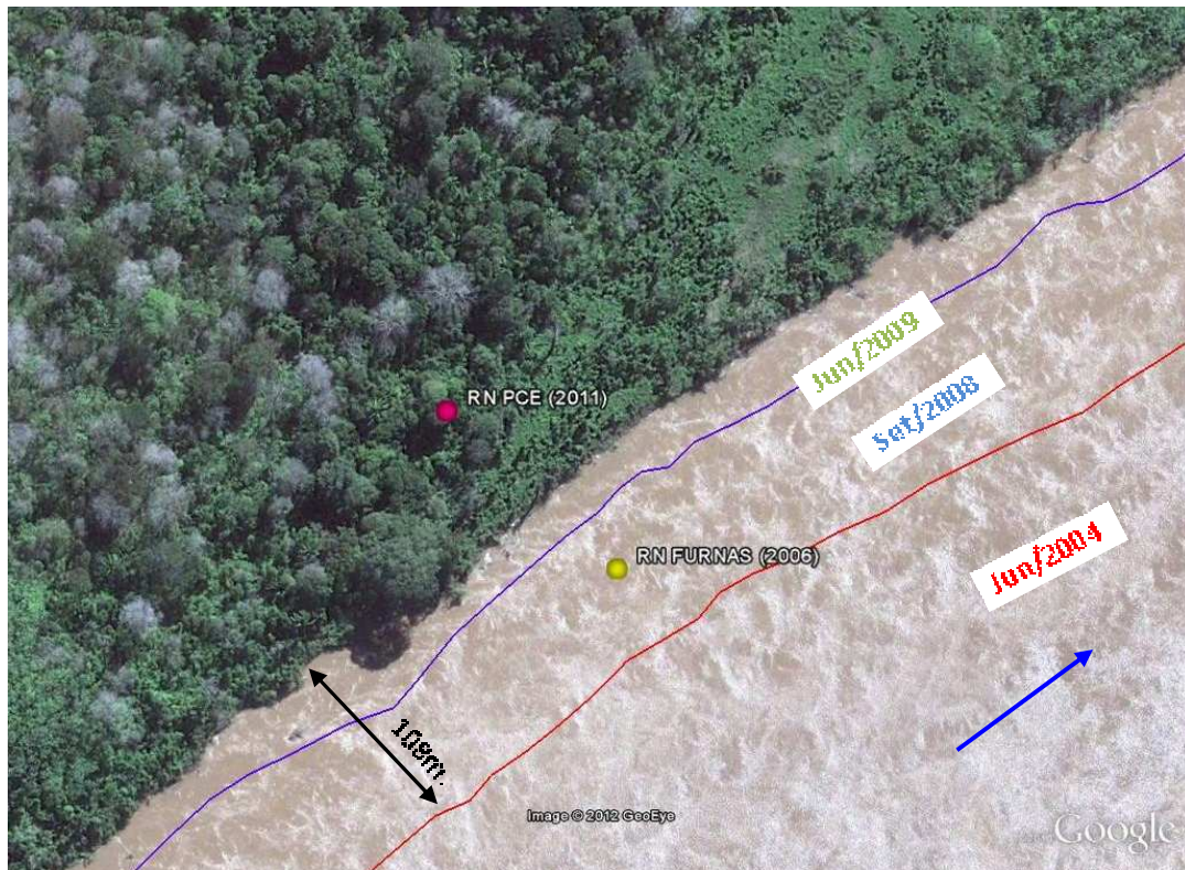
Figura 3.52. Erosão ao Longo da Margem Esquerda do Rio Madeira nas Imediações da ST 76,3
