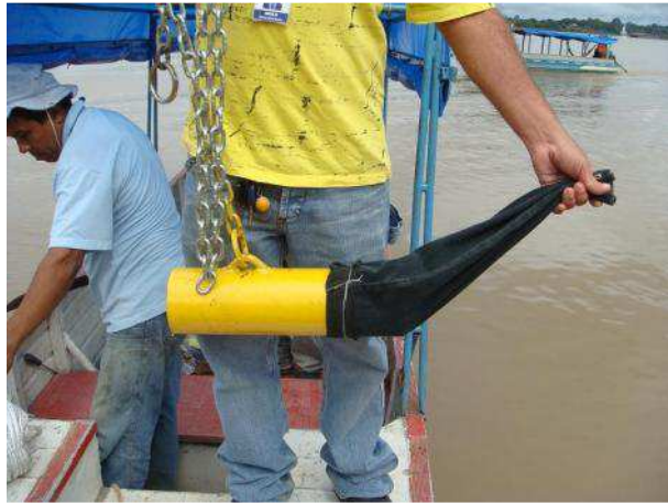
Figura 4.1. Amostrador de Sedimentos do Leito do Tipo de Raspagem Horizontal
